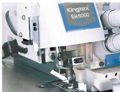
Ref. TC007 Cortador eléctrico guillotina de tira y cadeneta de accionamiento manual Cod. KIN0012
